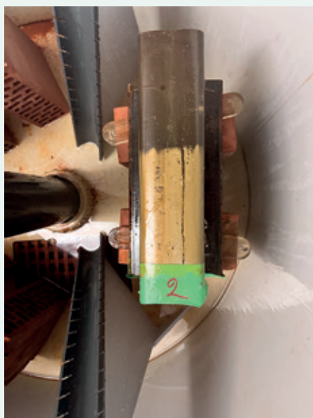
Comparaison sur ces 3 photos de l'efficacité de l'inhibition par test du brouillard salin (échantillons 1/2/3)
