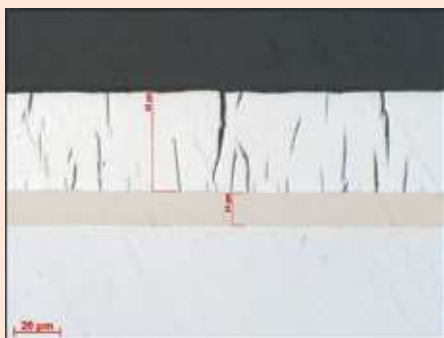
FIGURE 1 : Micrographie en coupe d'un dépôt de chrome obtenu à partir d'un bain au chrome trivalent. Un alliage de nickel est utilisé comme sous-couche pour améliorer la tenue à la corrosion (Image : CRM).
