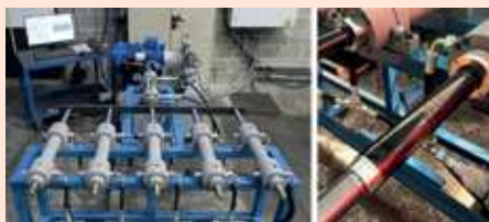
FIGURE 4 : Banc de test conçu et opéré par Schoonbroodt Hydraulics dans le cadre du projet HEI-Coat (M-Eranet) pour l'évaluation de substituts au chromage dur pour les tiges de vérins (à gauche) et tige avec revêtement carbure en cours de test.
