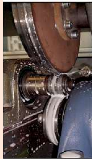
FIGURE 5 : Simulateur 3-disques développé par le CRM et utilisé (entre autres) pour l'évaluation de solutions de substitution au chromage dur des cylindres de laminage (à gauche) et mapping et analyse XRF linéaire de l'échantillon révélant des sites d'endommagement ponctuels du revêtement dans le sillon d'usure (à droite).
