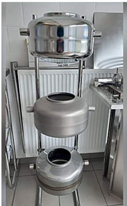
Componenten behandelen heeft een effect. De onderste tank werd niet behandeld en de middelste alleen maar gebeitst. De bovenste tank werd geamorfiseerd.
