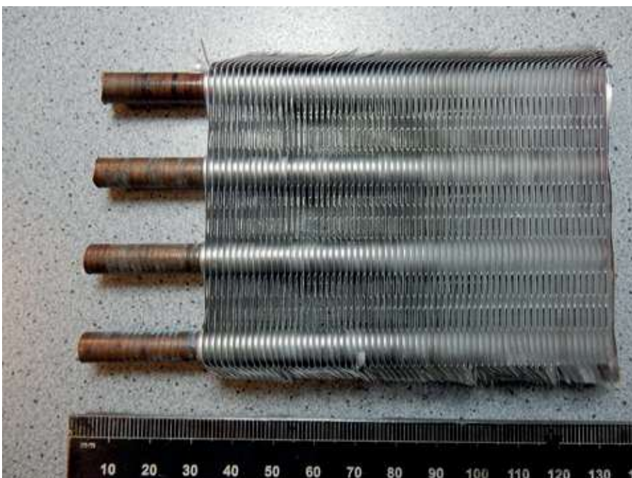
▲ Deel van de pijpenbundel na verwijdering van enkele koellamellen
