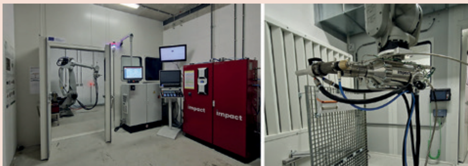
Figure 2 : Vue de l'équipement de projection cold spray installé au CRM Group.
